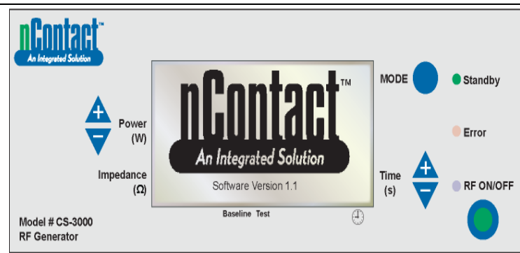
Figuur 9. Display voorpaneel RF-generator tijdens “Standby Mode”
